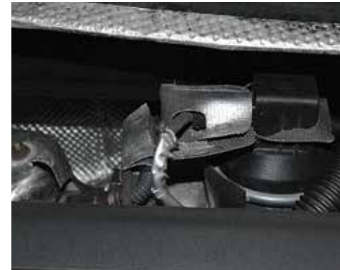
Beschädigung durch Nagetiere
