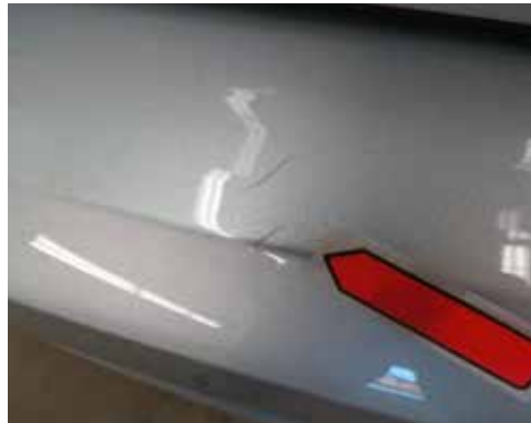
Kratzer in der Lackoberfläche
