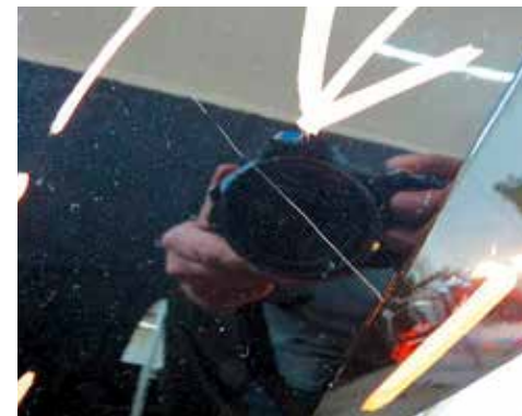
Beschädigung des Basislacks
